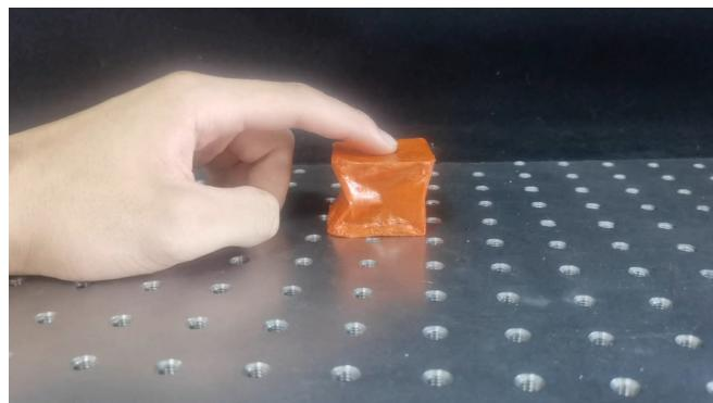
这一版的样机差强人意，最起码验证了直线驱动的可行性，但也告诉了我，如果不用刚性的机构进行约束，则不可能做到比较好的精度。所以，我才开始设计打印件的样机。
