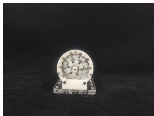
为了验证样机的效果，我们设计了如下实验：使用电机驱动减速器，进行固定扭矩的输入，利用力传感器测试输出端的输出力矩对时间的相应。我们也同时获取了电机电流数据作为辅助，可以一定程度上反映减速机系统对于输入端的反馈。
